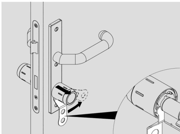
Illust. 20 : désassembler le cône du bouton
